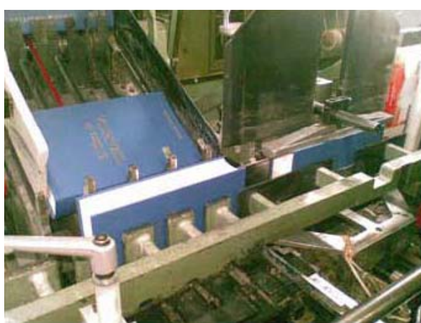
Les feuillets sont préparés pour la machine à relier
